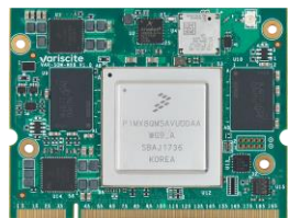
VAR-SOM-MX8 NXP I.MX8 2X 1.8GHZ CORTEX-A72 + 4X 1.2GHZ CORTEX-A53
