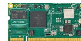
VAR-SOM-MX8M-NANO NXP I.MX8M NANO 4X 1.5GHZ CORTEX-A53
